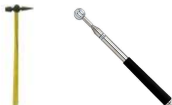
〔打診に使用する機材〕 テストハンマー
