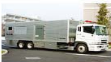
大型移動電源車
