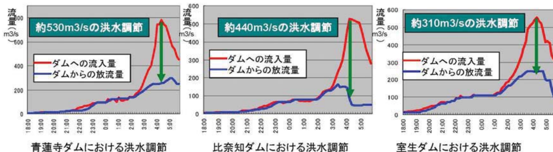
青蓮寺ダムにおける洪水調節
