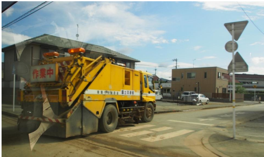
路面清掃車で路面上の土砂を除去
