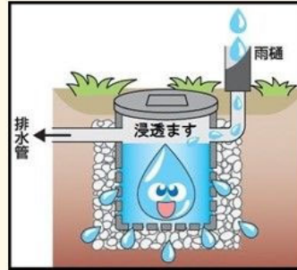
雨水浸透ます(屋根に降った雨を地下に浸透させる小さな穴の開いたます)
