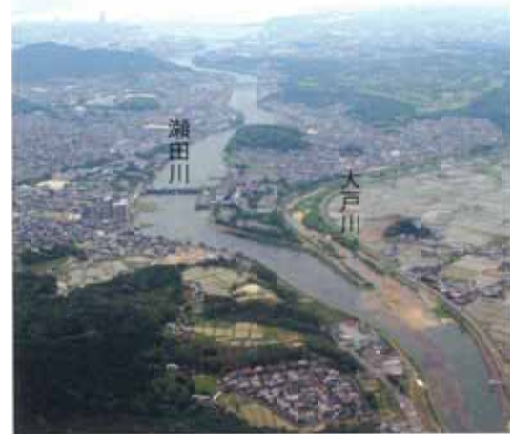
大戸川より流出する土砂によって瀬田川の疎通を阻害している。（瀬田川、大戸川、合流点）
