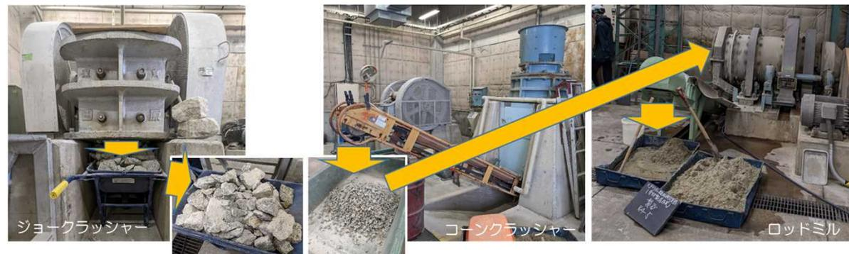
現地から採取した掘削ずりを骨材サイズまで碎いて試験を実施
