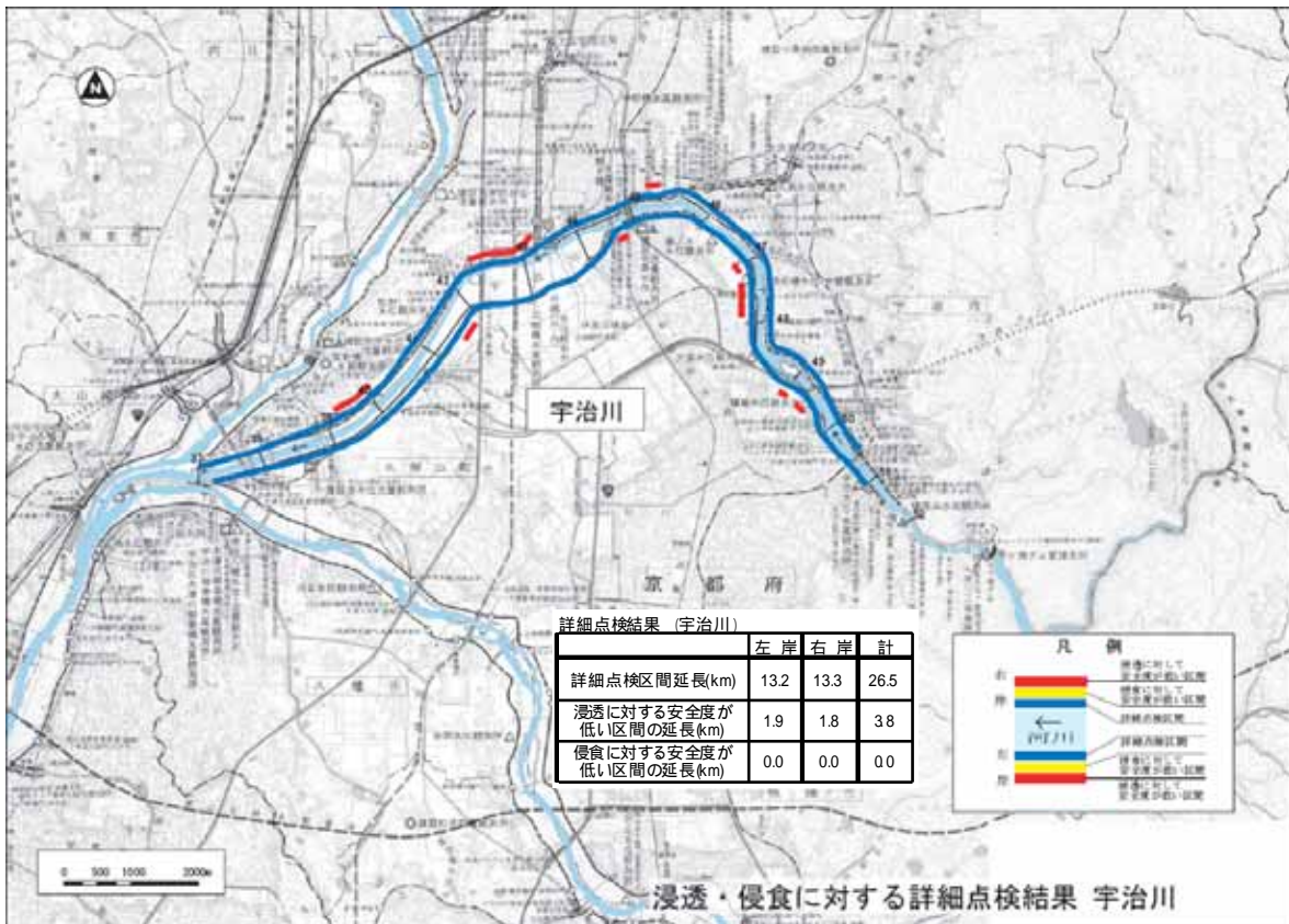
宇治川堤防の浸透・侵食に対する詳細点検結果
