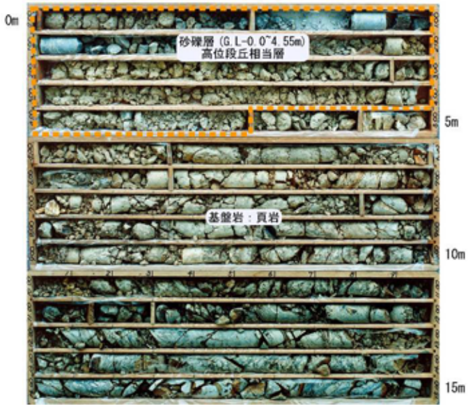
鉛直ボーリング No. 62 孔のコア状況
