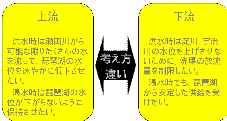
図 2.28 洗堰操作をめぐる上下流の考え方の違い
