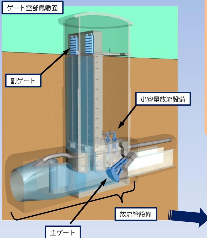
現在は、放流管設備のうちトランジション管、放流管の製作が最盛期です。
