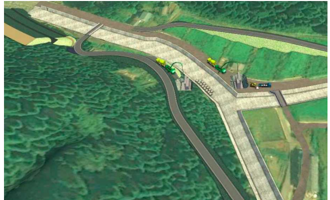
付替県道施工ステップ CIMモデル
