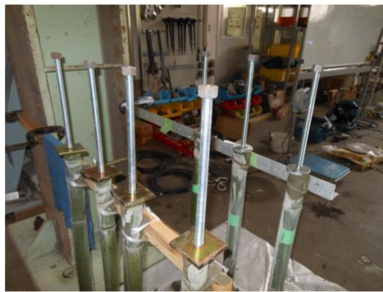
竹の中にM16全ネジボルト挿入モルタル充填
